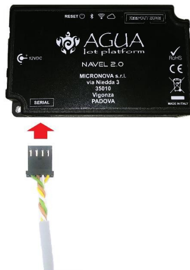
6. attēls. SĒRIĀLAIS kabelis un Wi-Fi modulis sakars
